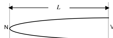
Fig.5.39. Primer armónico en un tubo sonoro.
