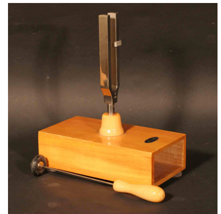
Fig.5.34. El sonido se transmite por el pie del diapasón que es un material sólido, hasta la caja de resonancia.
